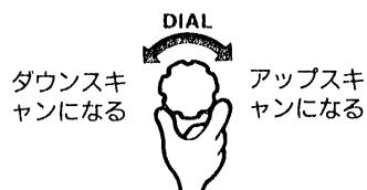
DIALを時計方向に回すとアップし、逆に回すとダウンします。
