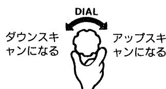
DIALを時計方向に回すとアップし、逆に回すとダウンします。
