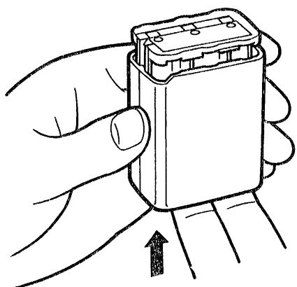
バッテリーケースの底を矢印の方向に押し上げて、電池ホルダーを取り出します。
