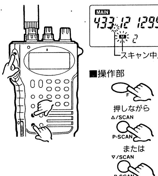
Fスイッチを押しながら△または▽キーを押すと、スキップチャンネルを飛び越えてスキャンします。
