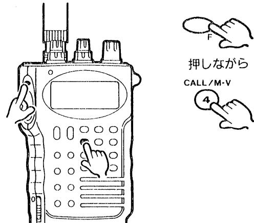
ビープ音が“ピッピピ”と鳴るまで、Fスイッチを押しながらM▶VFOキーを押します。
