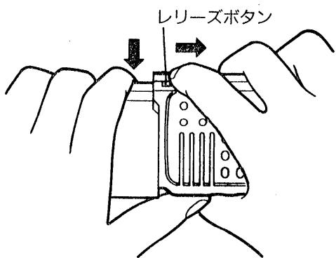
バッテリーケースの底を矢印の方向に押し上げて、電池ホルダーを取り出します。
