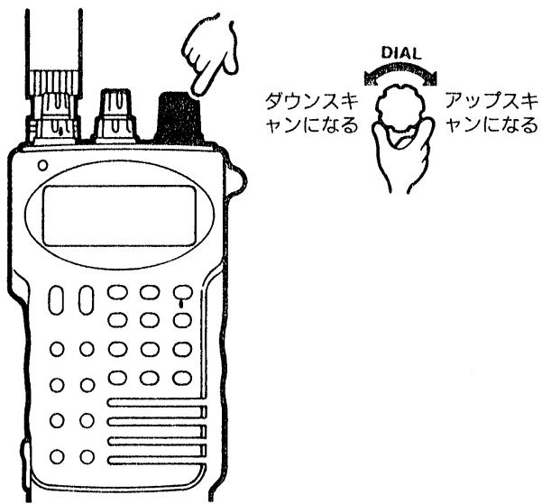
DIALを時計方向に回すとアップし、逆に回すとダウンします。
