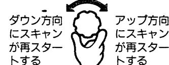
信号が途切れると約2秒後、信号が続いているときは約5秒後に再スタート(☞P48, 52)します。また、DIALを回すと強制的に再スタートします。
