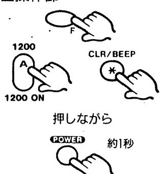
Fスイッチ、Aおよび\*キーを押しながらPOWERキーを約1秒押します。
